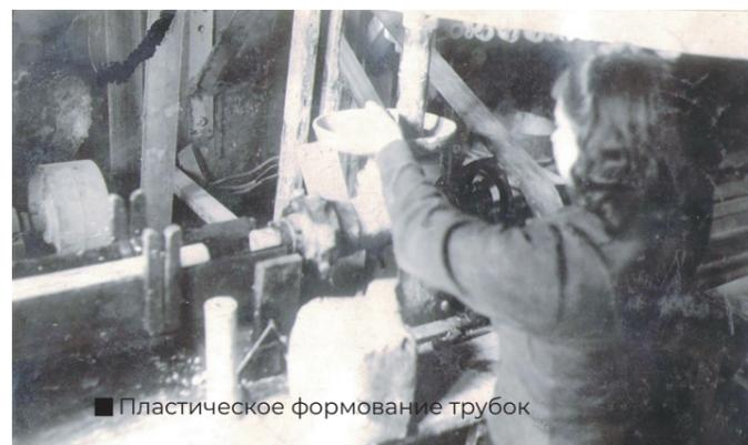
■ Пластическое формование трубок
